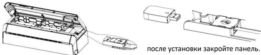
Модуль управления съёмный LT/ES подходит для сплит-систем серий Lite и Easy. Для подключения требуется поднять лицевую панель внутреннего блока, снять крышку блока электроподключений и вытянуть плату. Модуль подключается в разъём CN16 на плате управления, после установки модуля закрепите крышку и закройте панель.
